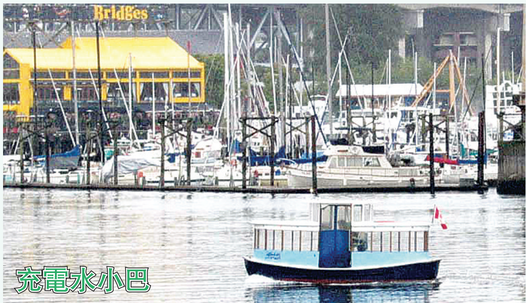
肩負搭載遊客來往於格蘭護島（Granville Island）和耶魯鎮（Yaletown）、日落海灘（Sunset Beach），以及英吉利灣（English Bay）的水上小巴，已經全面「綠化」，12艘小船全部裝設全新的電力馬達，取代使用多年的柴油馬達。新的電子馬達是使用電池，而且可以重複充電，可以達到零廢氣污染，減少對海洋和水中動植物的傷害。（圖文/王介中）
