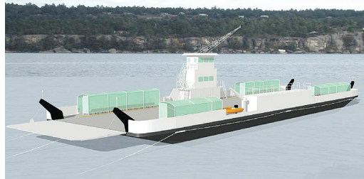
鋼纜渡輪設計圖。（卑詩渡輪公司）
