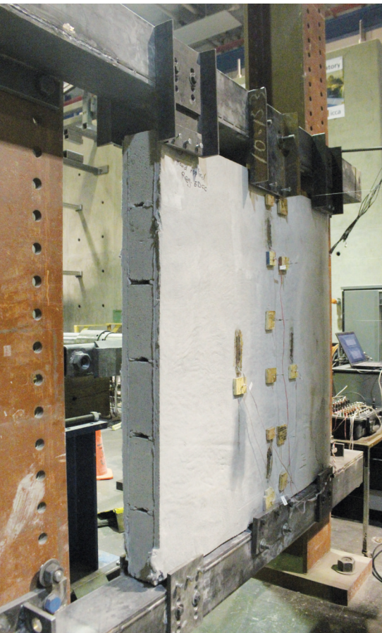
磚牆兩邊塗上EDCC便可加強建築的防震功能。（伍禮婷攝）
