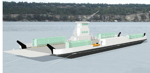
鋼纜渡輪設計圖。（卑詩渡輪公司）
