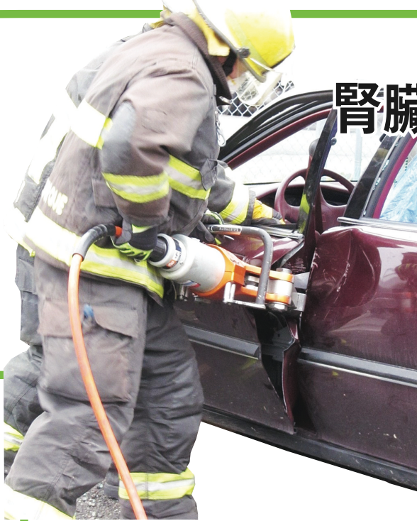
▲消防員示範拯救被困人士，用電鉗鉗開車門。 ▼揭開車頂後，消防員方可將被困人安全救出。(鄭綺霞攝)
