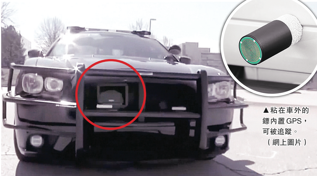
▲追蹤科技有助警察安全地執法。紅圈處為發射粘鏢的裝置。
