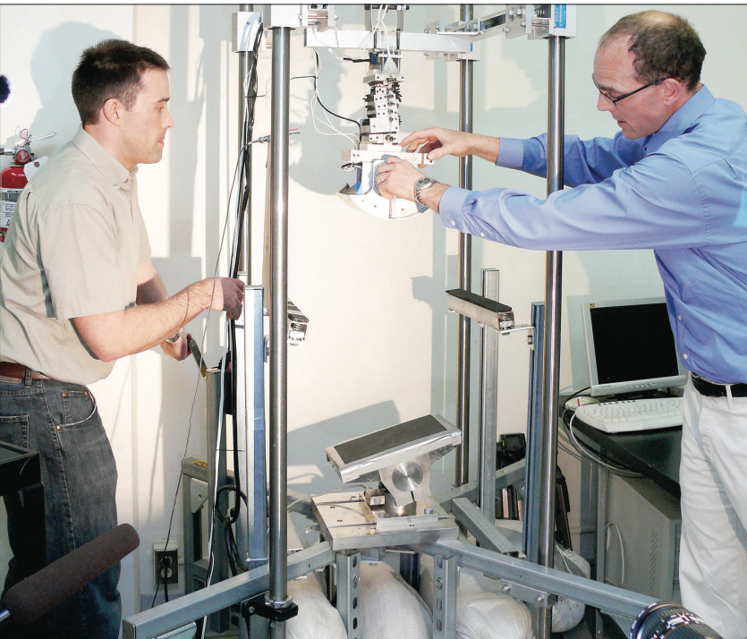
新頭盔的兩位研發者克里滕（右）和尼爾森在現場模擬頸椎受到撞擊後的情況。（馮亮攝）
